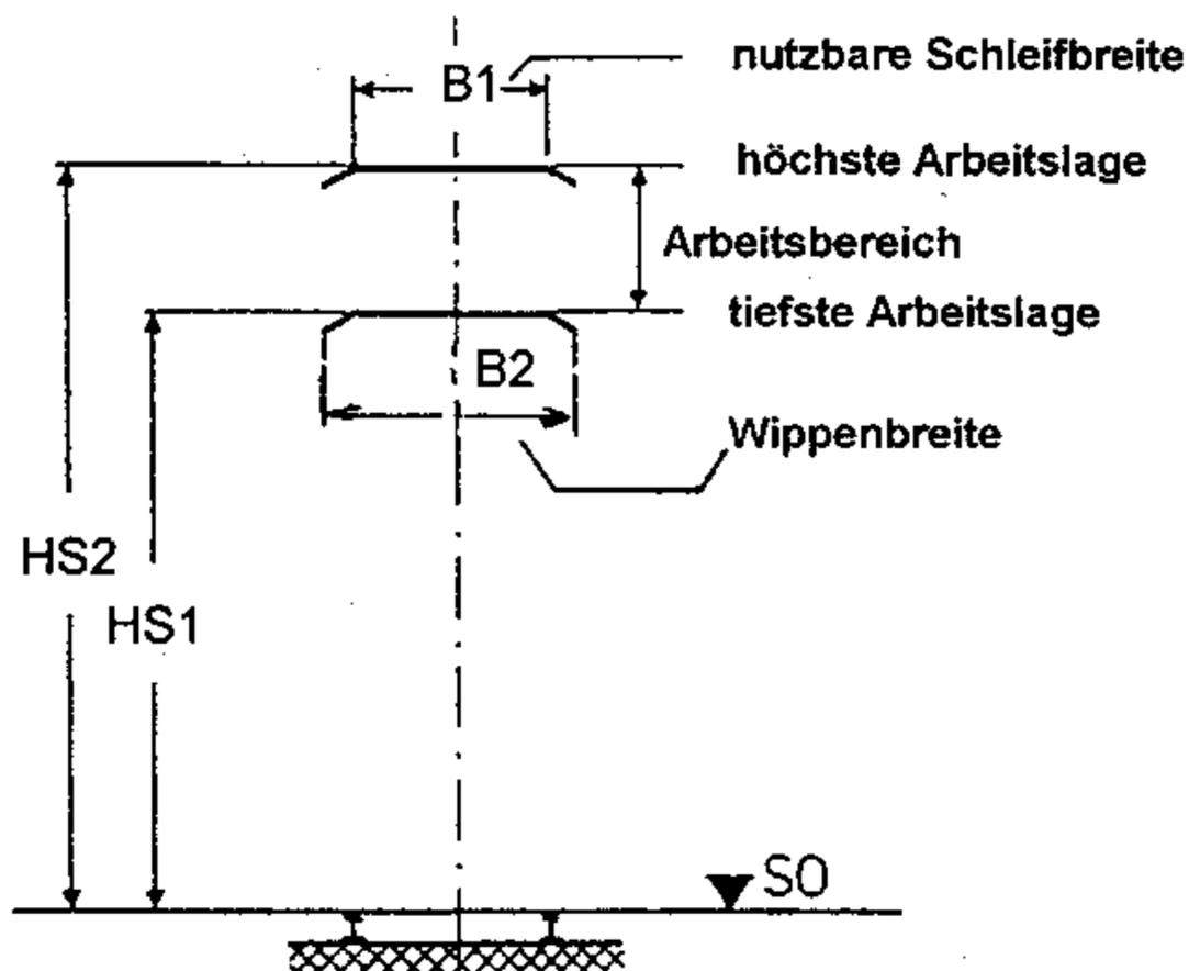
Anmerkung : die Rundung zwischen Schleifstück und Anlaufhorn, sowie die Neigung des Anlaufhorns und die gesamte Wippenbreite  $B2$  wird von den Vorbildstromabnehmern bestimmt. Keinesfalls darf aber das Breitenmaß ( $B2$ ) und das Höhenmaß  $H4$  des abgesenkten (in der Ruhelage befindlichen) Stromabnehmers nach NEM 301 überschritten werden.
