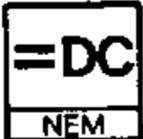
Das Fahrzeug ist für das Zweileiter-Gleichstrom-System ausgelegt und hat isolierte Radsätze
