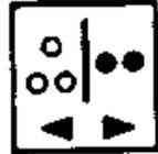
Zusatzkennzeichnung: Mit Fahrtrichtung wechselnd
