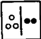
Darstellung durch Lichtpunkte (links = vorn, rechts = hinten), Beispiel: Dreilicht-Spitzensignal, zwei rote Schlußlichter
